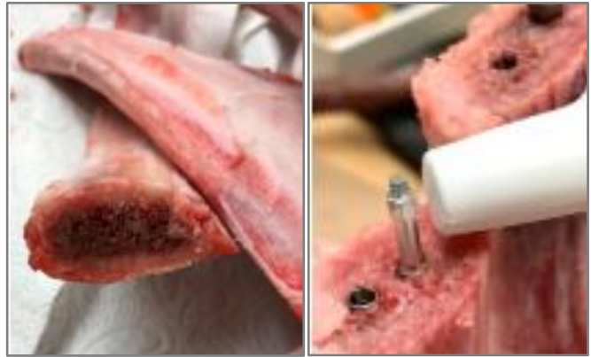
Abb. 1: In der Studie wurde der Teil der Rippen verwendet, der dem Typ 4 ähnlich war. Abb. 2: Für jedes Protokoll wurden die Implantate von demselben Kliniker in die ausgewählten Rinderrippen mit einem sicheren Abstand zueinander eingesetzt. Die Sonde des Osstell Mentor wurde in einem 90-Grad-Winkel 1 mm vom Magnetstift entfernt gehalten.
