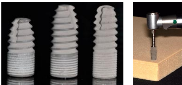
Abb. 1 (links): In dieser Studie verwendete Implantatabmessungen: (links) Implantatabmessung 4,8 × 10 mm; (Mitte) Implantatabmessung 4,8 × 12,5 mm; (rechts) Implantatabmessung 4,1 × 12,5 mm; Abb. 2 (rechts): Die Implantate wurden mit einem chirurgischen Motor in laminierten Polyurethanschaum eingesetzt, der in der Lage ist, das tatsächlich aufgebrachte Drehmoment über die Zeit aufzuzeichnen.
