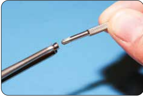
7: Einstellen der Haltekraft mit dem Aktivator.
