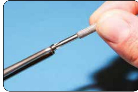
8: pro 1/4 Umdrehung wird die Haltekraft um ca. 200g erhöht.
