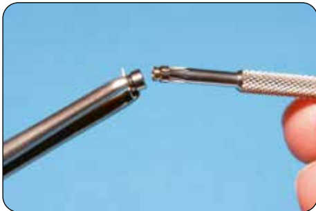
9: bei fortgeschrittener Kugelkopf-Abnutzung kann der Retentions-einsatz getauscht werden.
