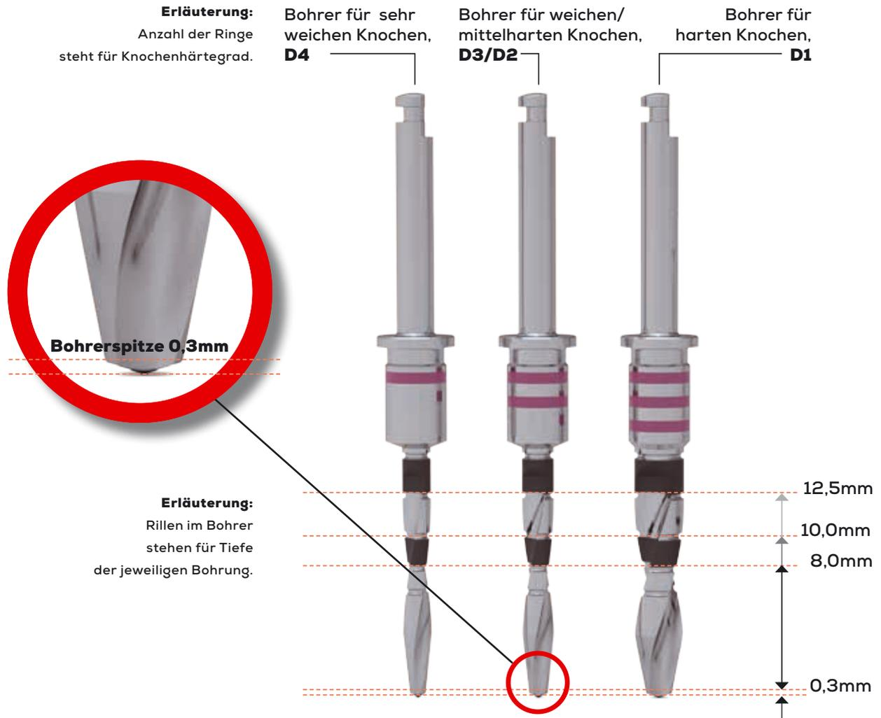
**Bei den ICX-NARROW Bohrern ist die Bohrlänge aufgrund der Bohrspitze um 0,3mm länger – bitte beachten Sie, dass bei der Bohrung dann auch die Bohrtiefe um zusätzlich 0,3mm zunehmen muss!**
